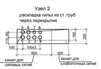
перечень кабелей, прокладываемых в ст. гильзах через перекрытия (Узел 2)
